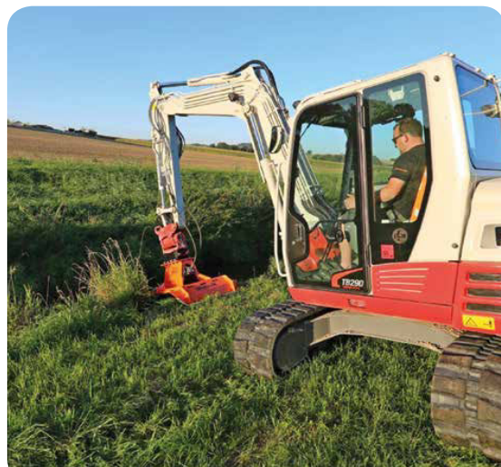
MULČOVAČ jako nástavba na běžné 7-14 t bagry.
