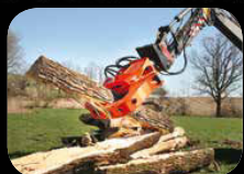
Woodcracker® L a W štípají přesílené kmeny k dalšímu zpracování.
