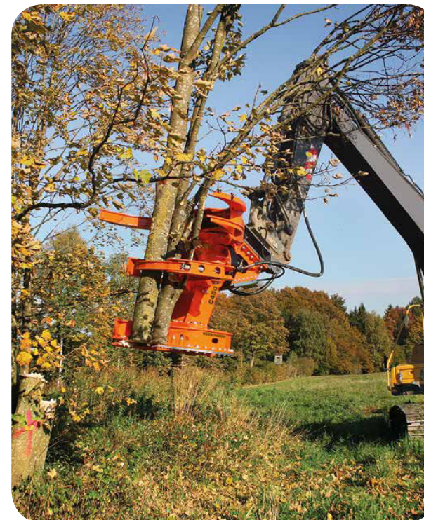
Woodcracker® C při těžbě energetického dřeva na okraji lesa.
