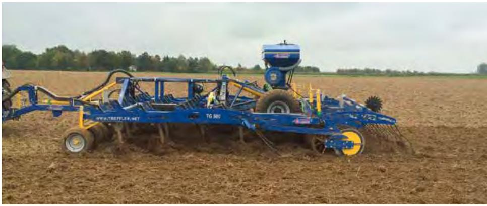
achse des Schleppers nicht mehr belastet wird, kann mit sehr niedrigem Reifenluftdruck gefahren werden. Dadurch und in Verbindung mit der flachen Stellung der 6 mm starken selbstschärfenden Gänsefußschare und
