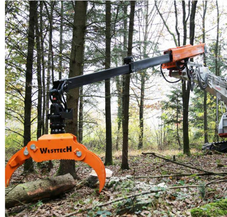
Die Telestufe erhöht die Reichweite ohne Umbauarbeiten am Trägerfahrzeug.
