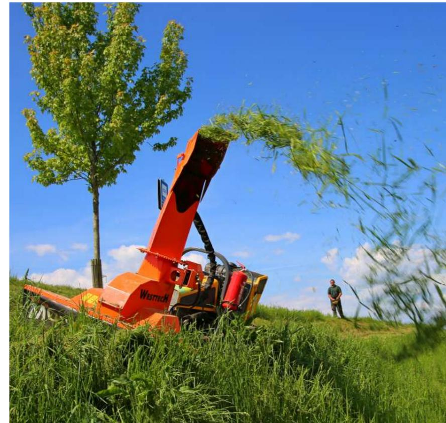
Der Mowblower® kann an ein ferngesteuertes Geräteträger angebaut werden.
