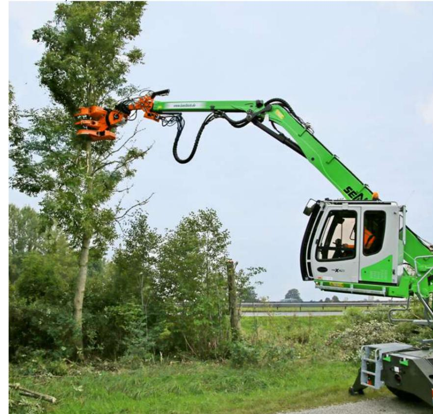
Der Verbindungslink kombiniert kardanischem und starren Anbau.
